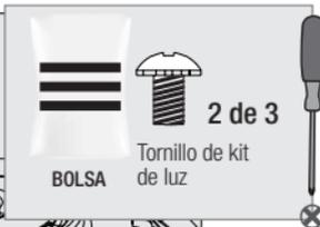
Atornille dos tornillos del conjunto de lámparas de la bolsa de materiales
