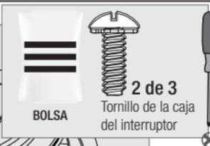
Atornille dos tornillos de montaje de la caja del interruptor, incluidos en la bolsa de materiales
