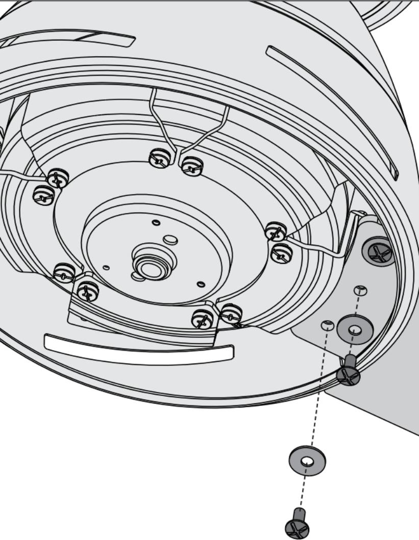
Fije cada aspa a un soporte de aspa usando las arandelas de aspa, que están en la bolsa ■, y los tornillos de montaje de aspa, que están en la bolsa ▲.
