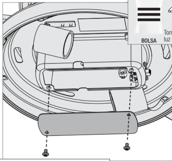
Empuje cuidadosamente todos los componentes de la caja del interruptor en la caja del interruptor, luego instale la placa de la caja del interruptor usando dos tornillos de ensamble del conjunto de lámparas que se encuentran en la
