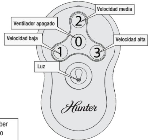
Para encender el ventilador, pulse un botón de velocidad. Las velocidades varían desde apagado (0) hasta alta (3). Presione brevemente el botón de luz para encender y apagar las luces.
