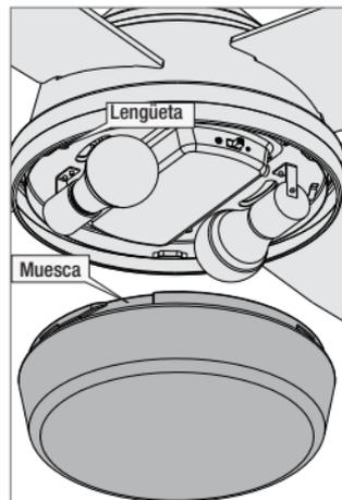
Levante el globo y alinee las muescas del globo con las pestañas del kit de luz.
