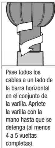
Pase todos los cables a un lado de la barra horizontal en el conjunto de la varilla. Apriete la varilla con la mano hasta que se detenga (al menos 4 a 5 vueltas completas).
