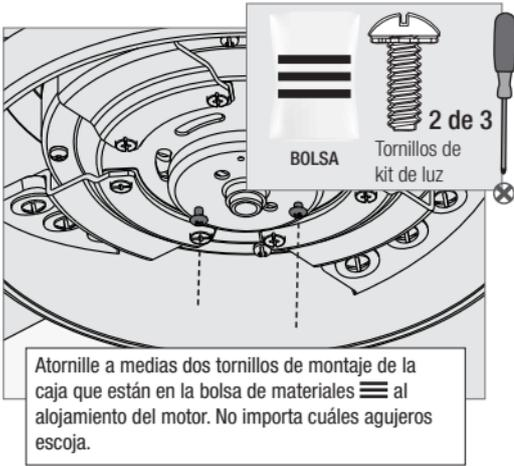
Atornille a medias dos tornillos de montaje de la caja que están en la bolsa de materiales
