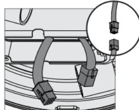
Conéctelo en el conector de enchufe que se encuentra en el área de la caja del interruptor del conjunto de lámparas. Asegúrese de alinear las marcas de color de los conectores.
