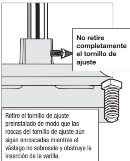
No retire completamente el tornillo de ajuste
