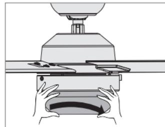
Para sujetar la pantalla de vidrio, levántela y hájala girar hacia la derecha un tercio de vuelta completa de la pantalla hasta que se detenga.
