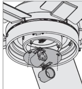
Alinee las ranuras de bocallave en el conjunto de luz con los tornillos de montaje. Asegúrese de que todos los alambres del ventilador y del conjunto de luz estén ajustados dentro del centro del conjunto de luz, y que no estén atascados entre la caja superior del interruptor y el conjunto de luz o colgando de los lados.
