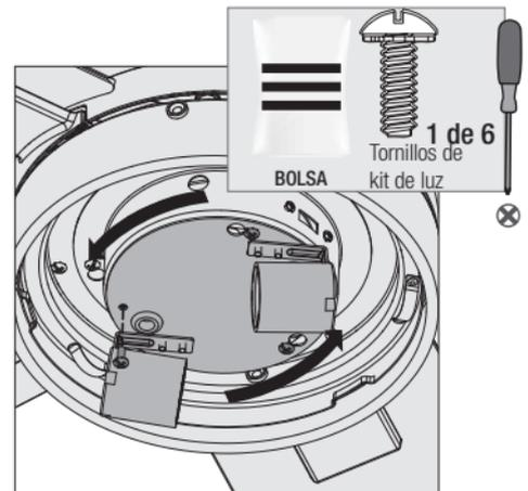
Gire el conjunto de luz en sentido antihorario hasta que los tornillos de ensamble de la caja estén firmemente colocados en el extremo angosto de las ranuras de bocallave. Instale el tornillo restante en la caja. Apriete los tres tornillos firmemente.
