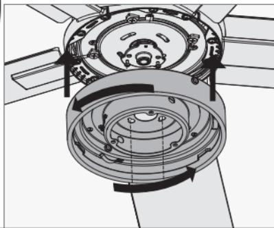
Pase la clavija del alambre a través del agujero central de la caja superior del interruptor, luego envuelva la ranura de bocallave alrededor de los tornillos y gire en sentido antihorario.
