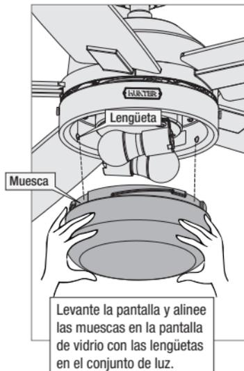
Levante la pantalla y alinee las muescas en la pantalla de vidrio con las lengüetas en el conjunto de luz.
