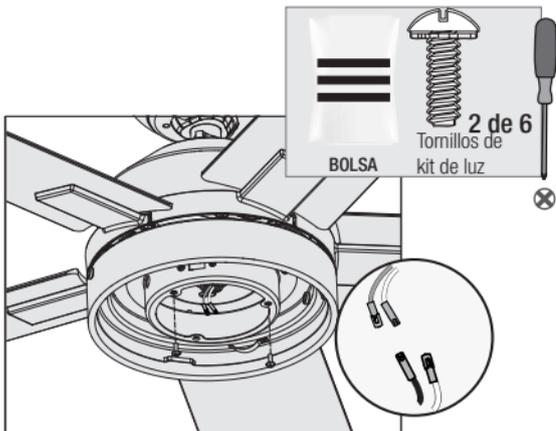
Instale parcialmente dos de los tornillos de kit de luz que están en la bolsa . No importa cuáles agujeros escoja. Conecte el cable blanco del ventilador al cable blanco del conjunto de lámparas. Luego, conecte el cable blanco del ventilador al cable negro y azul del conjunto de lámparas.
