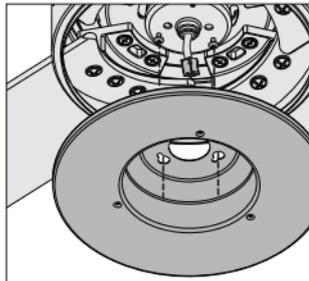
Pase la clavija del alambre a través del agujero central de la caja superior del interruptor, luego envuelva la ranura de bocallave alrededor de los tornillos y gire en sentido antihorario.
