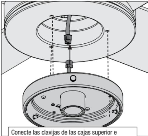
Conecte las clavijas de las cajas superior e inferior del interruptor. Asegúrese de alinear las marcas de color de los conectores. Levante la caja inferior del interruptor hasta que sus orificios para tornillos estén alineados con los orificios para tornillos en la caja superior del interruptor.
