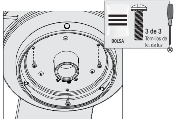
Instale los tres tornillos de ket de luz, que se encuentran en la bolsa de materiales
