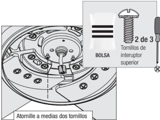
Atornille a medias dos tornillos de montaje de la caja que están en la bolsa de materiales
