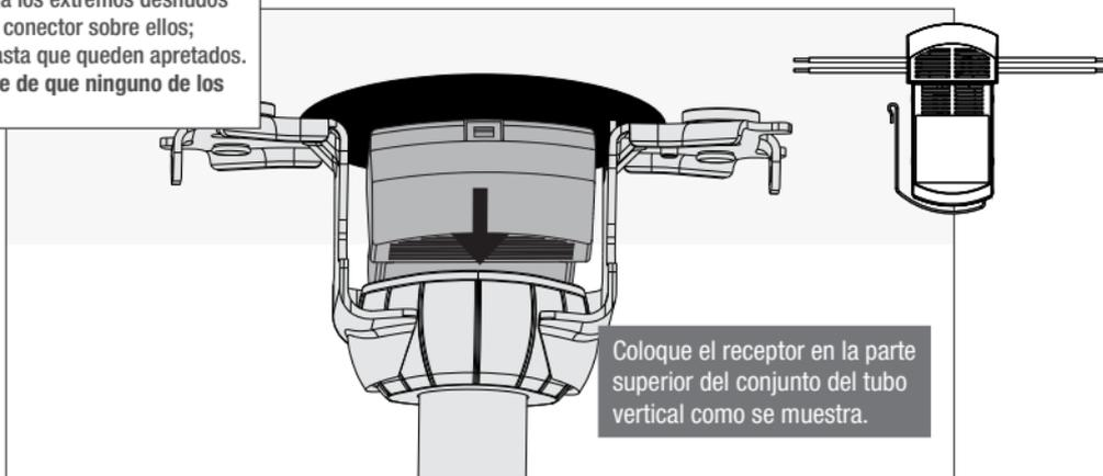
Coloque el receptor en la parte superior del conjunto del tubo vertical como se muestra.
