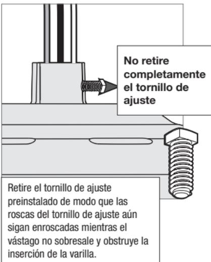
**No retire completamente el tornillo de ajuste**
