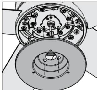
Pase la clavija del alambre a través del agujero central de la caja superior del interruptor, luego envuelva la ranura de bocallave alrededor de los tornillos y gire en sentido antihorario.
