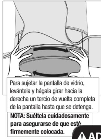
Para sujetar la pantalla de vidrio, levántela y hágala girar hacia la derecha un tercio de vuelta completa de la pantalla hasta que se detenga.
