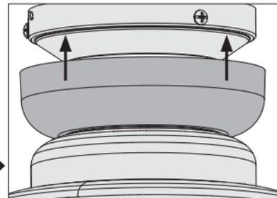
Con las dos manos empuje el anillo de la moldura de campana hasta la parte superior de la campana. Escuchará un clic y el anillo de la moldura de campana quedará asegurado en posición.
