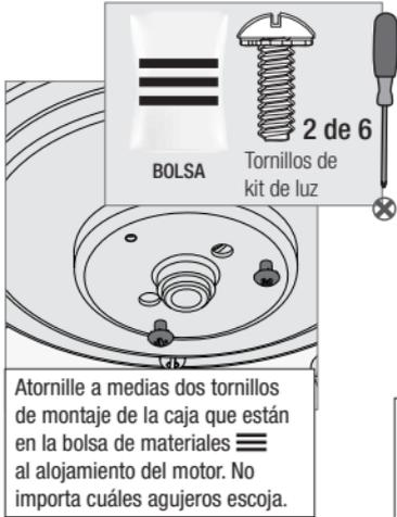
Atornille a medias dos tornillos de montaje de la caja que están en la bolsa de materiales
