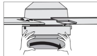
Para sujetar la pantalla de vidrio, levántela y hágala girar hacia la derecha un tercio de vuelta completa de la pantalla hasta que se detenga.
