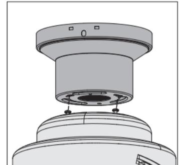
Pase los alambres del ventilador a través del orificio central de la campana, luego coloque las ranuras tipo bocallave alrededor de los tornillos de la campana y gire en sentido contrario a las agujas del reloj.
