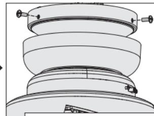
Sostenga arriba la campana con los orificios para tornillos bien alineados. Instale parcialmente dos tornillos de la campana, que se encuentran en la ● bolsa de materiales, dentro de los orificios opuestos a los ganchos del soporte de suspensión.
