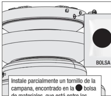
Instale parcialmente un tornillo de la campana, encontrado en la ● bolsa de materiales, que está entre los ganchos del soporte de suspensión. Cuando los orificios estén bien alineados, apriete firmemente los tres tornillos de la campana.
