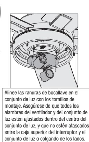
Alinee las ranuras de bocallave en el conjunto de luz con los tornillos de montaje. Asegúrese de que todos los alambres del ventilador y del conjunto de luz estén ajustados dentro del centro del conjunto de luz, y que no estén atascados entre la caja superior del interruptor y el conjunto de luz o colgando de los lados.
