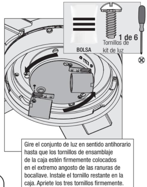
Gire el conjunto de luz en sentido antihorario hasta que los tornillos de ensamble de la caja estén firmemente colocados en el extremo angosto de las ranuras de bocallave. Instale el tornillo restante en la caja. Apriete los tres tornillos firmemente.
