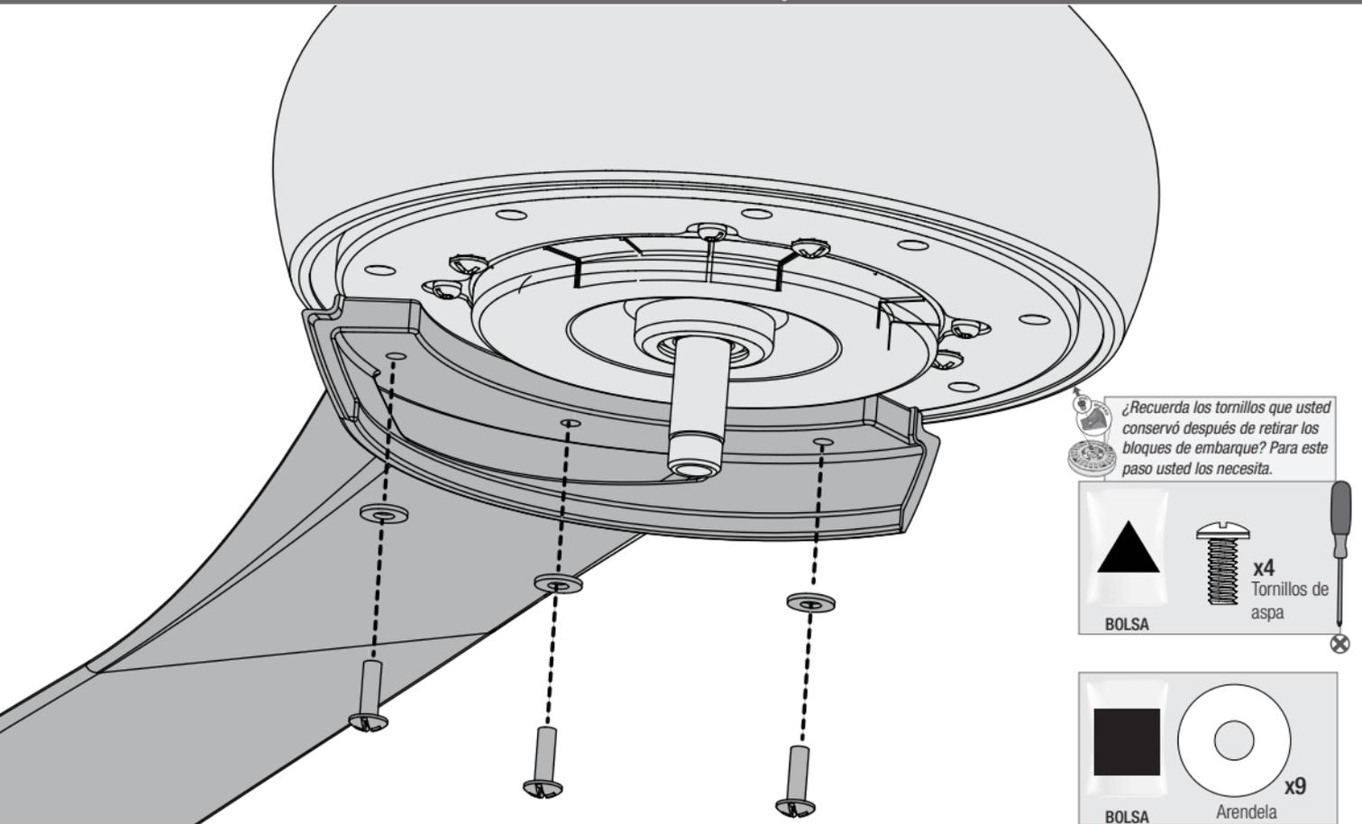
¿Recuerda los tornillos que usted conservó después de retirar los bloques de embarque? Para este paso usted los necesita.
