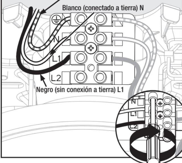
Conecte los alambres procedentes del techo al bloque de terminales (ubicado en el costado del soporte de campana) y apriete utilizando un destornillador de cabeza plana (incluido).
