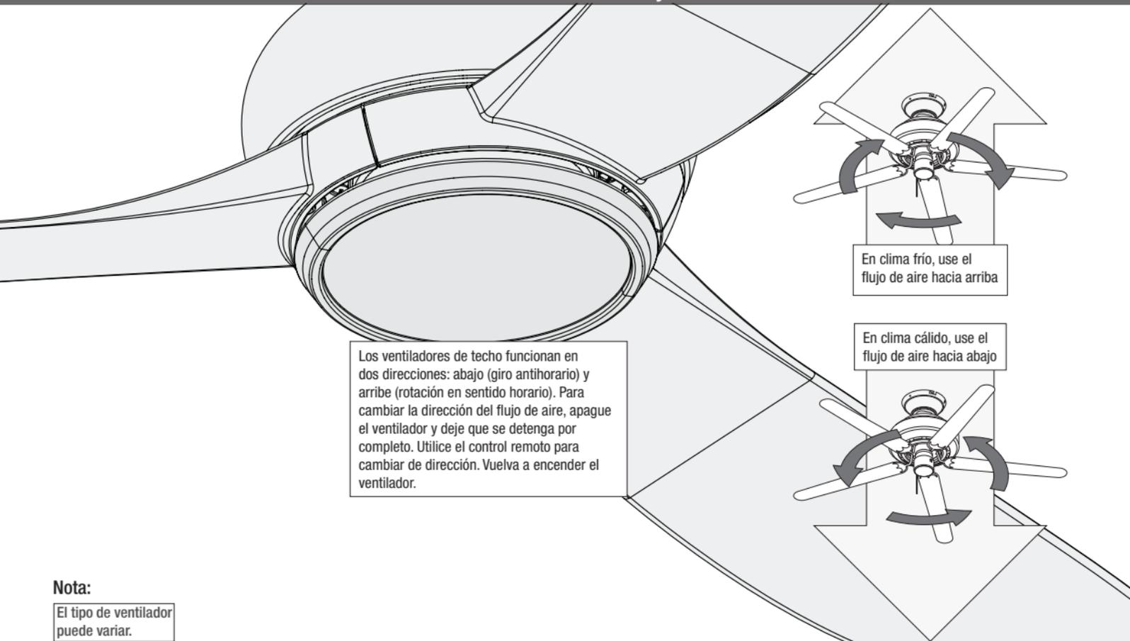
Los ventiladores de techo funcionan en dos direcciones: abajo (giro antihorario) y arriba (rotación en sentido horario). Para cambiar la dirección del flujo de aire, apague el ventilador y deje que se detenga por completo. Utilice el control remoto para cambiar de dirección. Vuelva a encender el ventilador.
