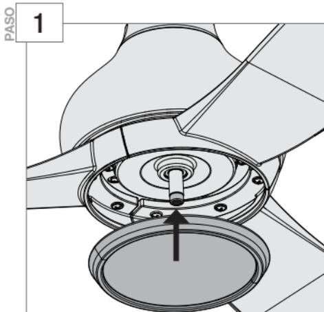
Levante la tapa y alinee con el centro del vástago roscado del ventilador.
