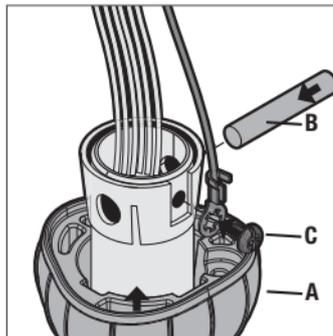
Vuelva a instalar el pasador metálico pequeño (B) y el tornillo de conexión a tierra (C). Deslice hacia arriba la bola (C).
