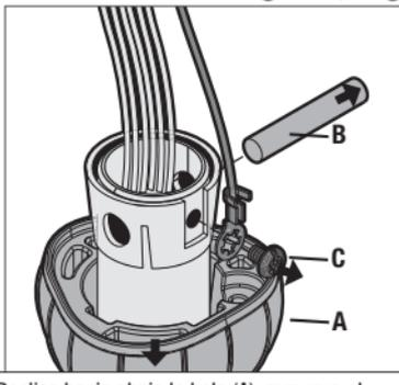
Deslice hacia abajo la bola (A), remueva el pasador metálico pequeño (B) y el tornillo de conexión a tierra (C).
