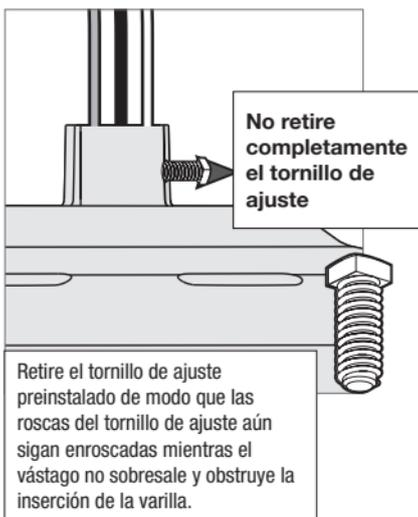
No retire completamente el tornillo de ajuste
