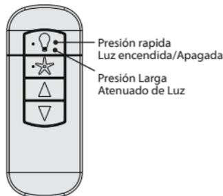
Presione brevemente el botón de luz para apagar y encender las luces. Mantenga el botón de luz presionado para aumentar o disminuir la intensidad lumínica.
