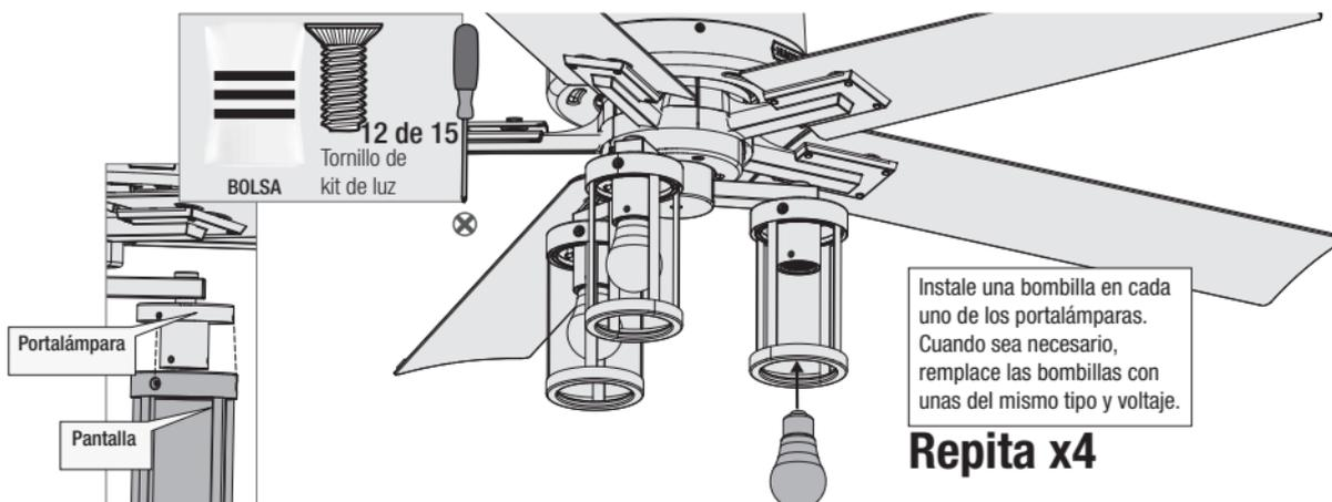
Levante el conjunto de vidrio hasta que sus orificios para tornillo estén alineados con los orificios para tornillo de uno de los portafocos del conjunto de lámpara. Asegure con los tres tornillos del conjunto de lámpara que se encuentran en la bolsa de tornillería .
