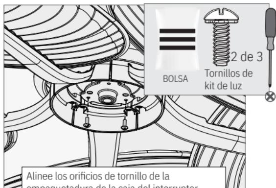
Alinee los orificios de tornillo de la empaquetadura de la caja del interruptor. Atornille a medias dos tornillos de montaje de la caja que están en la bolsa de materiales
