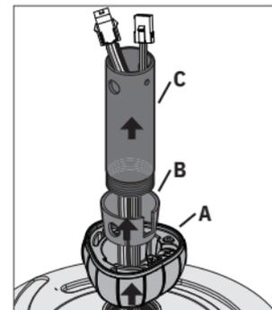
Remueva la bola (A), el manguito (casquillo) interior (B) y el tubo de soporte (C) fuera del cuerpo del ventilador y de los conjuntos de alambres.
