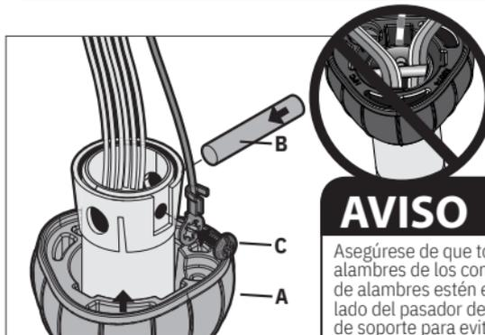
Vuelva a instalar el pasador metálico pequeño (B) y el tornillo de conexión a tierra (C). Deslice hacia arriba la bola (C).
