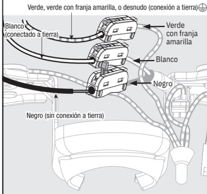
Conecte los alambres procedentes del techo al bloque de terminales (ubicado en el costado del soporte de campana) y apriete utilizando un destornillador de cabeza plana (incluido).
