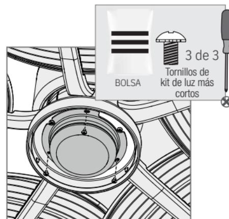
Instale los tres tornillos de caja del interruptor incluidos en la bolsa de materiales
