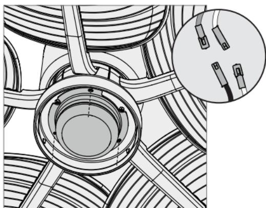
Conecte el cable blanco del ventilador al cable blanco del conjunto de lámparas. Luego, conecte el cable azul del ventilador al cable negro del conjunto de lámparas.
