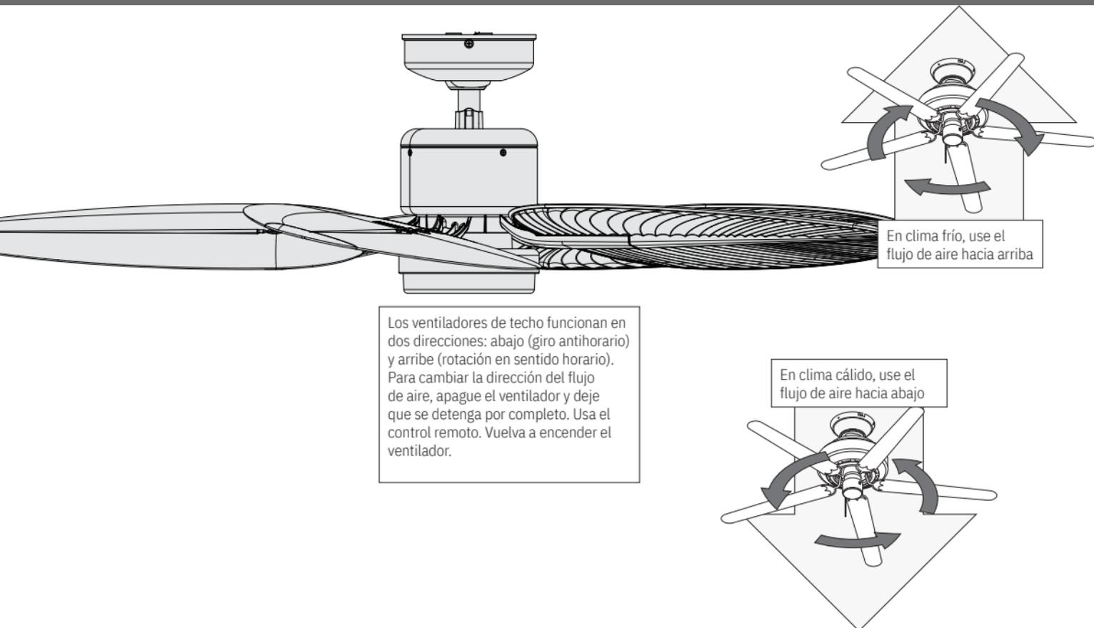
Los ventiladores de techo funcionan en dos direcciones: abajo (giro antihorario) y arriba (rotación en sentido horario). Para cambiar la dirección del flujo de aire, apague el ventilador y deje que se detenga por completo. Usa el control remoto. Vuelva a encender el ventilador.
