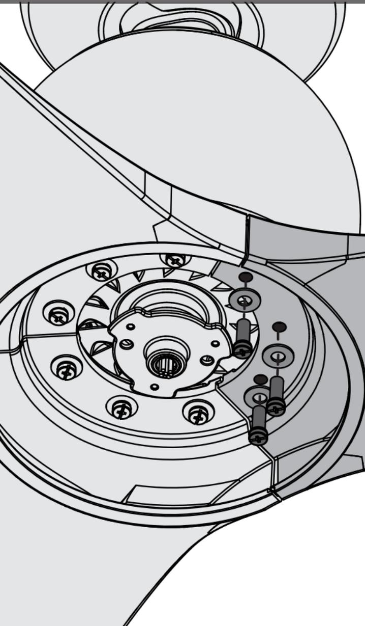
Coloque las arandelas de paleta incluidas en la bolsa de materiales ■ en los tornillos de paleta incluidos en la bolsa de materiales ▲. A continuación instale los tornillos de paleta para fijar ambas paletas al soporte de paleta.
