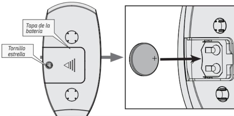
Para acceder al compartimiento de la batería quite el pequeño tornillo estrella (Phillips) que fija la tapa del compartimiento al conjunto del transmisor. Contáctese con su centro local de reciclaje de baterías para obtener información adecuada para el desecho de la batería.
