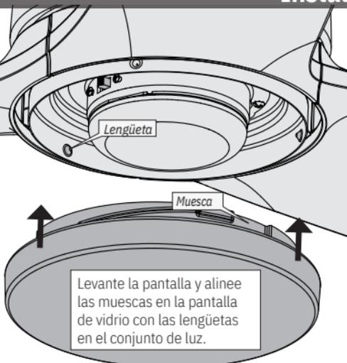
Levante la pantalla y alinee las muescas en la pantalla de vidrio con las lengüetas en el conjunto de luz.
