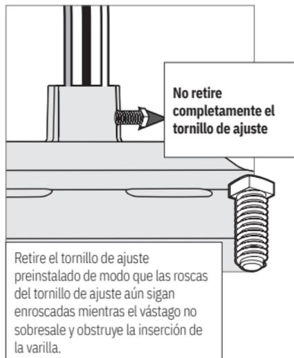
No retire completamente el tornillo de ajuste
