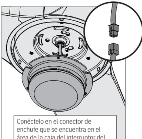
Conéctelo en el conector de enchufe que se encuentra en el área de la caja del interruptor del conjunto de lámparas. Asegúrese de alinear las marcas de color de los conectores.
