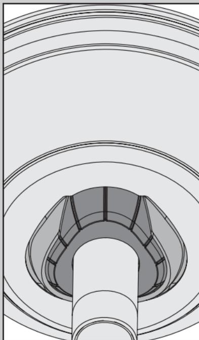
Coloque la campana de modo que, cuando sea levantada para ponerla en posición, encaje en el soporte de suspensión como se muestra.
