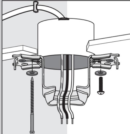
**Use tornillo para madera de 3"** (incluido) para asegurar a la estructura de soporte con la caja de salida eléctrica aprobada. Taladre agujeros piloto de 9/64" en la estructura de soporte para ayudar a asegurar el soporte de techo con los materiales de la bolsa ★.
