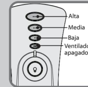
El botón de desconexión del ventilador solo apaga el ventilador. Para encender el ventilador debe presionar uno de los botones de velocidad.
