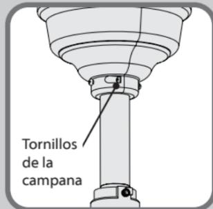
Si su ventilador ya está instalado y la campana es sostenida por dos tornillos cerca del tubo vertical como se muestra, siga las **INSTRUCCIONES DE ENSAMBLE TIPO B.**
