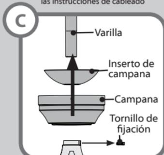
Retire el tubo vertical desatornillando el tornillo de fijación inferior. Desatornille el tubo vertical. Retire la campana y el inserto de la campana. Vuelva a instalar el tubo vertical de acuerdo al manual del ventilador.
