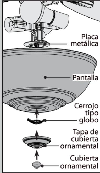
Presione la pantalla y el cerrojo tipo globo al ras de la placa metálica. Pase la cadena de la luz a través del orificio situado en el centro de la tapa de cubierta ornamental y pase la cadena del ventilador a través del orificio situado en el costado de la tapa. Finalmente pase únicamente la cadena de la luz a través del orificio situado en la cubierta ornamental y enrosque la cubierta ornamental en la varilla roscada.
