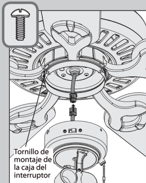
Instale parcialmente dos de los tornillos de las cajas del interruptor que están en la bolsa ≡. Conecte las clavijas de las cajas superior e inferior del interruptor. Asegúrese de alinear las marcas de color de los conectores.
