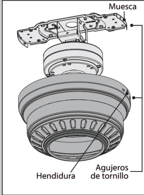
Levante el alojamiento del motor por encima del motor y del soporte de techo. Gire el alojamiento del motor de modo que los orificios de los tornillos queden alineados y la hendidura en las trabas del alojamiento queden en posición con la muesca situada en el soporte de techo. **El alojamiento del motor no está asegurado hasta que no se completa el paso siguiente. No lo deje sin supervisión.**
