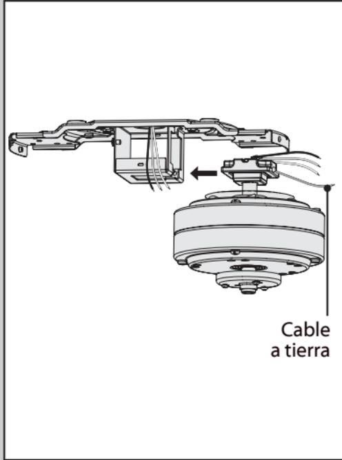
Mantenga apartados los cables, levante el conjunto del motor y coloque el soporte cuadrado en la abertura del soporte de techo. Asegúrese de que el cable a tierra conectado al soporte esté hacia afuera de la abertura grande en el soporte de techo.
