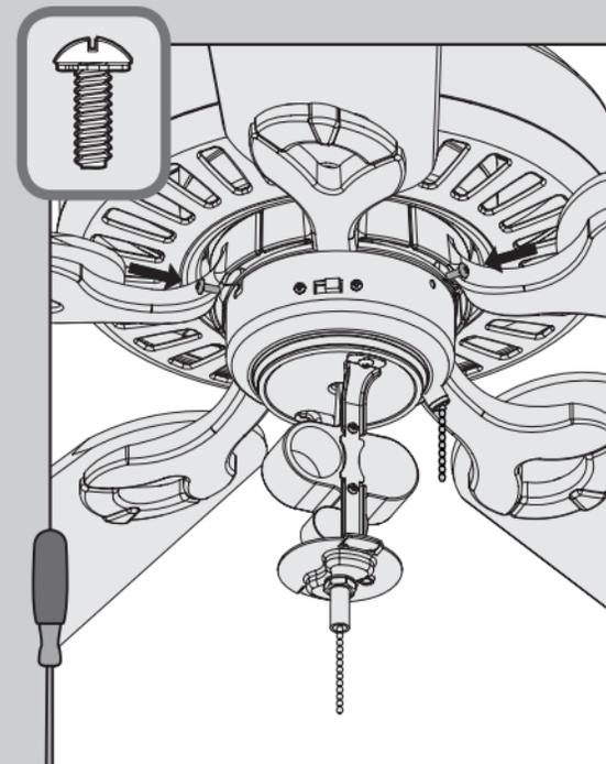
Instale el tercer tornillo de montaje de la caja. Apriete los tres tornillos firmemente.
