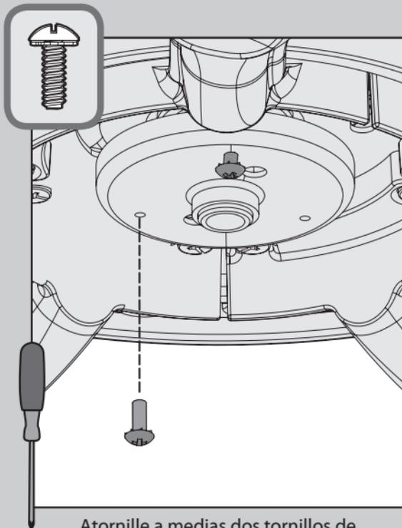
Atornille a medias dos tornillos de montaje de la caja que están en la bolsa de materiales
