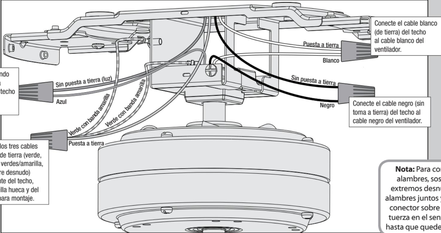
Conecte los tres cables de toma de tierra (verde, con raya verdes/amarilla, o de cobre desnudo) procedente del techo, de la varilla hueca y del soporte para montaje.
