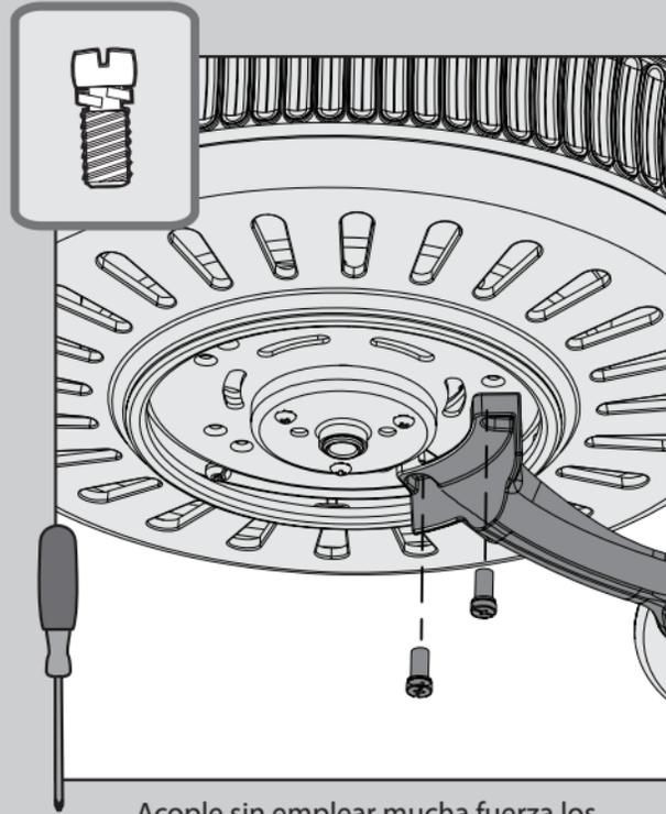
⊗ Acople sin emplear mucha fuerza los soportes de paleta al motor con los tornillos de la bolsa de materiales ✕, luego apriete con firmeza, cuando ambos tornillos estén acoplados.
