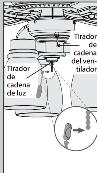
Retire y deseche los conectores de plástico de los extremos de las cadenas colgantes (si es necesario). Conecte el pendiente del tirador de cadena adecuado a cada una de las cadenas cortas que vienen de la caja del interruptor.
