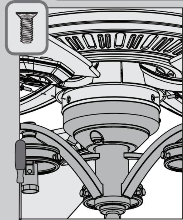
⊗ Instale los tres tornillos de caja del interruptor incluidos en la bolsa de materiales ≡.
