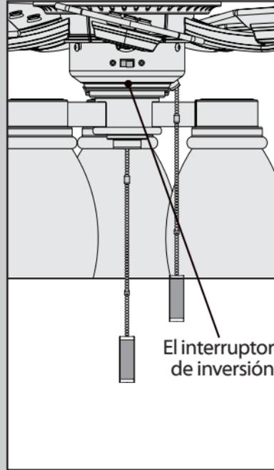
Para cambiar la dirección del flujo de aire, mueva el interruptor de inversión a la posición opuesta.
