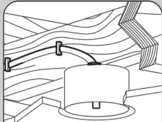
Debe tener la capacidad de asegurar al ventilador a la estructura de la edificación o caja de salida aprobada para ventiladores
