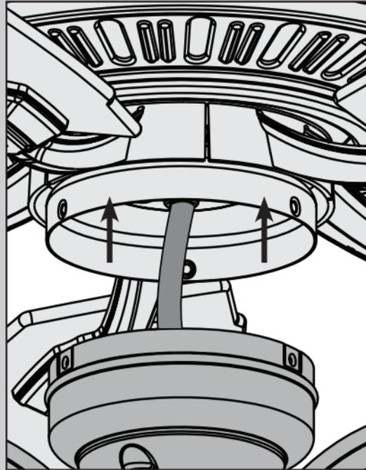
Levante la caja inferior del interruptor hasta que los orificios de tornillo estén alineados con los orificios de tornillo situados en la caja superior del interruptor.
