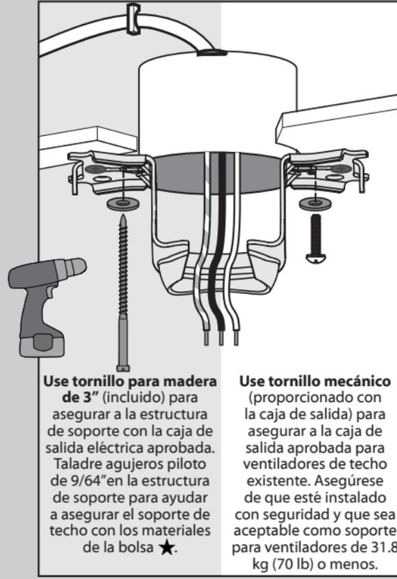
**Use tornillo para madera de 3"** (incluido) para asegurar a la estructura de soporte con la caja de salida eléctrica aprobada. Taladre agujeros piloto de 9/64" en la estructura de soporte para ayudar a asegurar el soporte de techo con los materiales de la bolsa ★.
