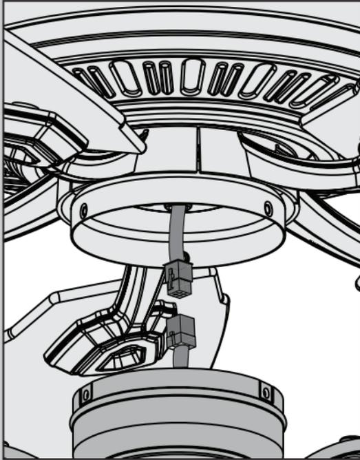
Conecte las clavijas de las cajas superior e inferior del interruptor. Asegúrese de alinear las marcas de color de los conectores.
