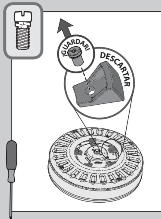
⊗ Retire los bloques para transporte del motor. **Guarde los tornillos. Serán necesarios para la instalación del soporte de paleta.**
