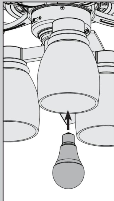
Instale las bombillas LED incluidas en los portalámparas. Cuando sea necesario, reemplace las bombillas con unas de la misma potencia.
