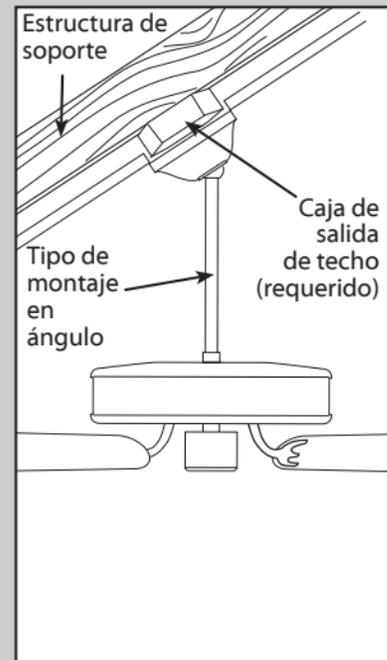
Emplee **un montaje de ángulo** para suspender el ventilador de un techo abovedado o en ángulo.
