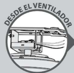
Usando un conector de alambre anaranjado de la bolsa de materiales ★, conecte los 3 alambres de puesta a tierra (verde, verde con banda amarilla, y cobre desnudo) del ventilador, la varilla y el soporte de suspensión.
