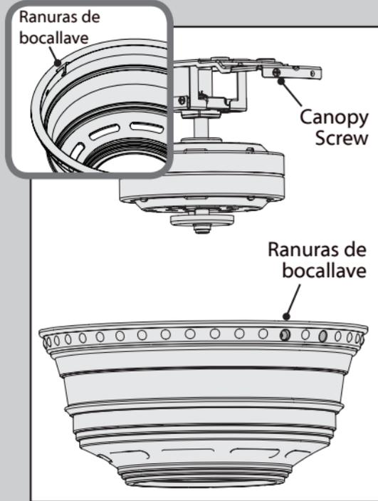
Coloque la caja del ventilador sobre el motor. Alinee las ranuras de bocallave en la caja del ventilador con los dos tornillos de campana parcialmente instalados en el soporte de suspensión. Gire la caja del ventilador para ubicar los tornillos en los extremos estrechos de las ranuras de bocallave. **El alojamiento del motor no está asegurado hasta que no se completa el paso siguiente. No lo deje sin supervisión.**
