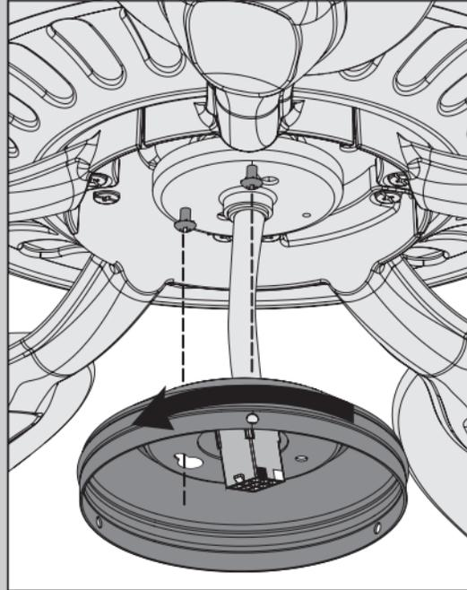
Pase la clavija del alambre a través del agujero central de la caja superior del interruptor, luego envuelva la ranura de bocallave alrededor de los tornillos y gire en sentido antihorario.
