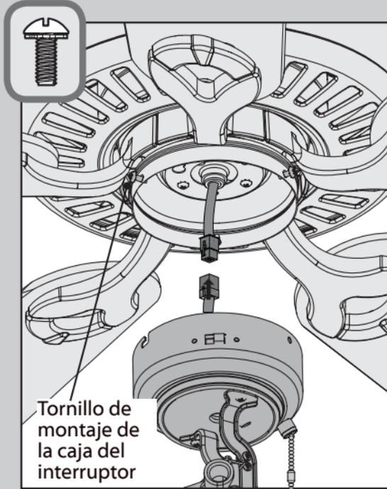
Instale parcialmente dos de los tornillos de las cajas del interruptor que están en la bolsa
