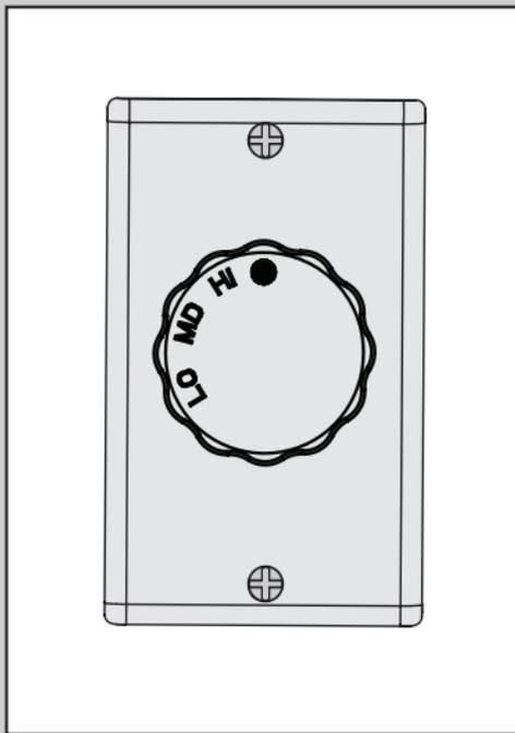
Vuelva a colocar la perilla en el control de pared y gírela hacia la izquierda para la posición OFF (apagado).
