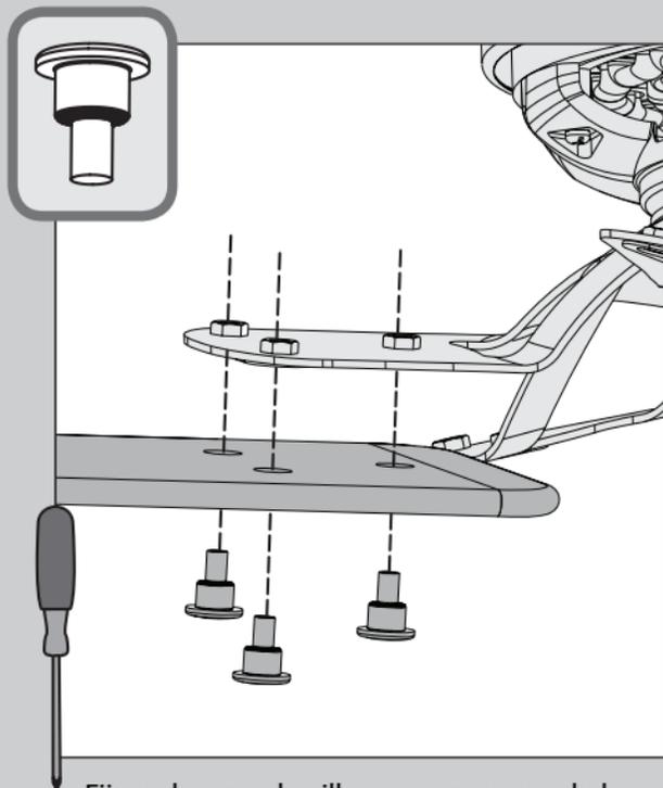
⊗ Fije cada aspa al anillo para aspas usando los tres tornillos para ensamblar aspas, que se encuentran en la ▲ bolsa de herrajes.
