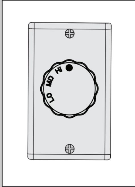
La perilla de la unidad de control de pared ajusta la potencia del ventilador. El ventilador tiene cuatro velocidades en secuencia: alta, media, baja y apagado.
