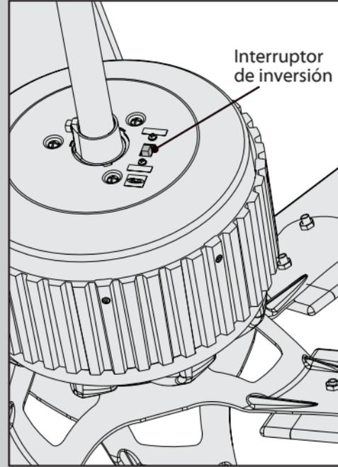
Para cambiar la dirección del flujo de aire, mueva el interruptor de inversión a la posición opuesta.
