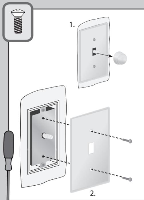
⊗ Retire la perilla del control de pared y monte la carátula (no incluida) en el control de pared usando los dos tornillos #6-32 que retiró anteriormente de la carátula.
