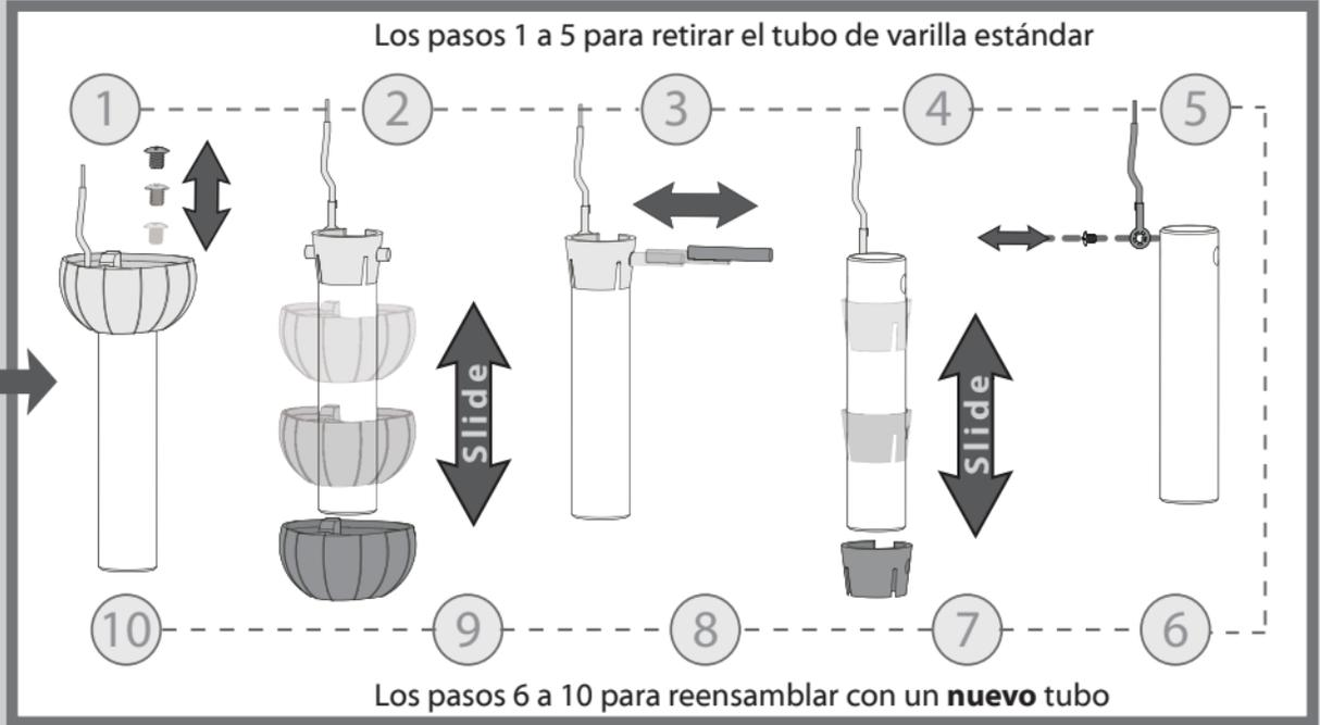
**Consejo:** Si usted tiene dificultad para insertar los cables a través del tubo vertical, intente adherir con cinta los cables a una varilla de espiga delgada, luego deje caer la varilla de espiga y los cables a través del tubo vertical. Asegúrese de retirar toda la cinta adhesiva una vez que los cables hayan pasado hasta el otro lado.
