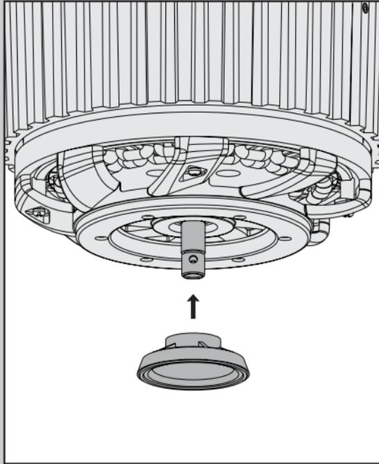
Enrosque la cubierta ornamental en la varilla roscada del motor.
