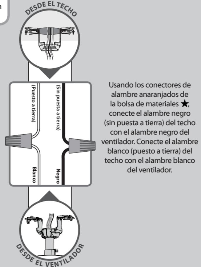
Usando los conectores de alambre anaranjados de la bolsa de materiales ★, conecte el alambre negro (sin puesta a tierra) del techo con el alambre negro del ventilador. Conecte el alambre blanco (puesto a tierra) del techo con el alambre blanco del ventilador.
