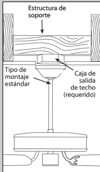
Emplee **un montaje estándar** para suspender el ventilador de un techo plano.
