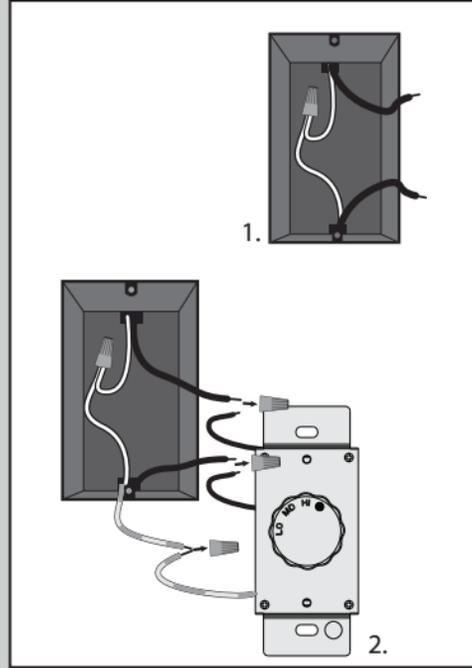
Al usar los conectores de cables, conecte cada uno de los cables negros desde el control de la pared al cable negro proveniente de la caja del interruptor. Conecte cada uno de los cables verde con banda amarilla desde el control de la pared al cable de puesta a tierra proveniente de la caja del interruptor.
