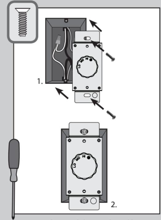
Inserte el control de pared en el la caja de distribución y asegúrela con dos pestañas de metal a las pestañas en la caja del interruptor usando los dos tornillos de cabeza plana que vienen con la caja del interruptor.
