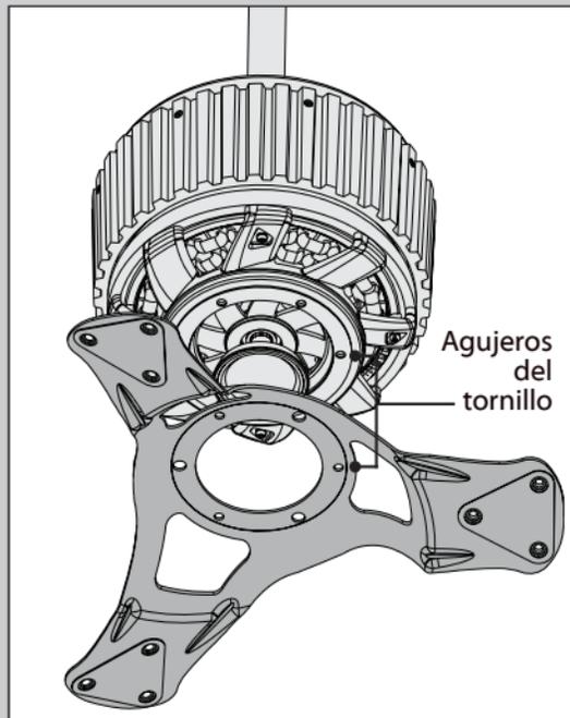
Levante un anillo para aspas al conjunto del motor y alinee los orificios para los tornillos.
