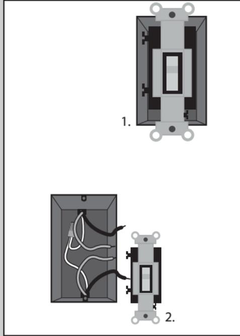
Corte la alimentación a la habitación donde estará trabajando en el tablero de interruptores. Después de retirar la placa de cubierta del interruptor, retire todo cableado del interruptor.
