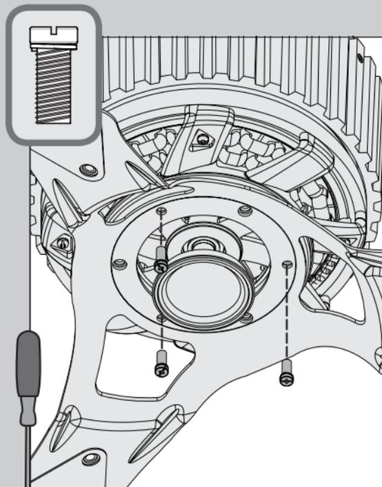
Instale los tres tornillos para fijar el asa, que se encuentran en la X bolsa de herrajes.
