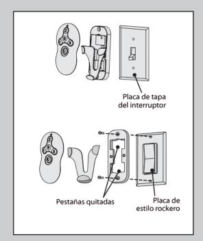
Para instalar el soporte del transmisor, quite los dos tornillos que sujetan la placa de tapa del interruptor. No retire la placa de tapa. Para orientar el soporte, alinee los dos orificios de montaje con los orificios de la placa de tapa. Coloque y apriete los tornillos. No apriete en exceso.
