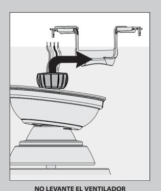
**AGARRANDO LA CAMPANA O LOS** CABLES. Coloque la bola de la varilla en la ranura del soporte de techo.
