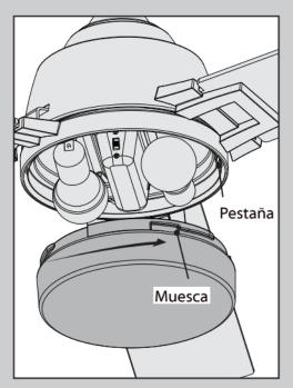
Ubique las muescas del borde externo de la pantalla de vidrio de modo que se alineen con las pestañas en la superficie interna del borde del artefacto de iluminación. Levante cuidadosamente la pantalla dentro del artefacto de iluminación tanto como sea posible. Gire la pantalla en sentido horario hasta que esté sujetada firmemente.
