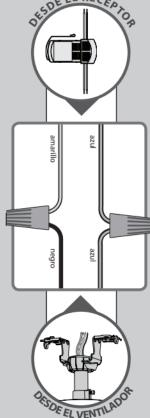
Usando los conectores de cable anaranjados de la bolsa de materiales ★:
