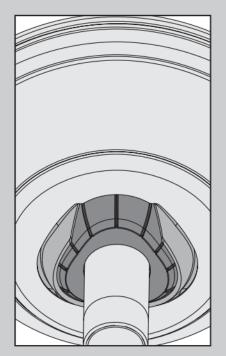
Coloque la campana de modo que, cuando sea levantada para ponerla en posición, encaje en el soporte de suspensión como se muestra.
