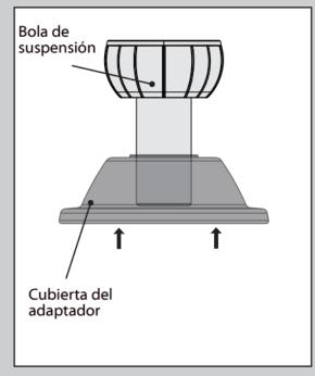
Deslice la cubierta del adaptador hacia el tubo de soporte hasta que descanse sobre la bola de suspensión.
