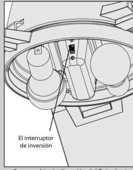
Para cambiar la dirección del flujo de aire, mueva el interruptor de inversión a la posición opuesta.
