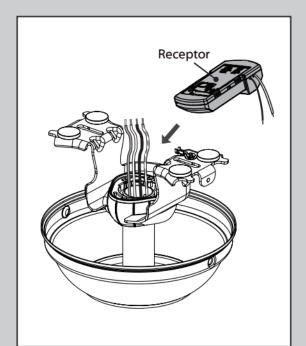
Coloque el receptor en la parte superior del conjunto del tubo vertical como se muestra.
