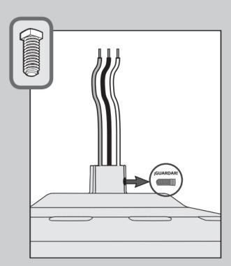
Retire el tornillo de fijación preinstalado de modo que se pueda insertar la varilla.
