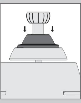
Baje la cubierta del adaptador hasta que descanse a nivel contra el alojamiento del motor.
