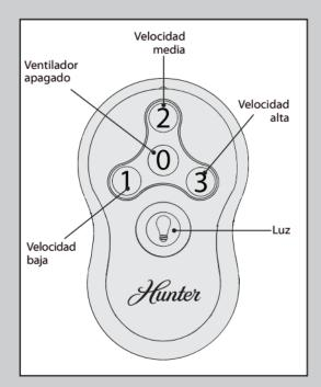
Para encender el ventilador, pulse un botón de velocidad. Las velocidades varían desde apagado (0) hasta alta (3). Presione brevemente el botón de luz para encender y apagar las luces.
