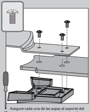
aspa como se muestra usando los tornillos del ensamble del aspa, que se encuentran en la ▲ bolsa de herrajes.
