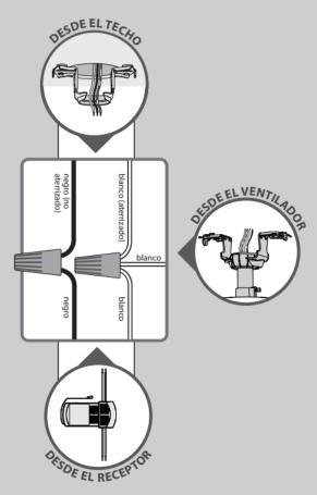
Gire los empalmes hacia arriba y presiónelos cuidadosamente hacia atrás a través del soporte de suspensión dentro de la caja de salida. Separe los alambres, con los alambres puestos a tierra a un lado de la caja de salida y los alambres no puestos a tierra al otro lado de la caja de salida.
