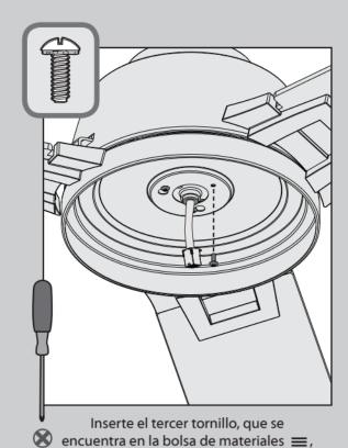
Asegúrese de que la caja superior del interruptor esté fijada firmemente a la placa de montaje. La fijación y el ajuste incorrectos de los tres tornillos de montaje del conjunto pueden causar que el accesorio de la caja del interruptor caiga.
