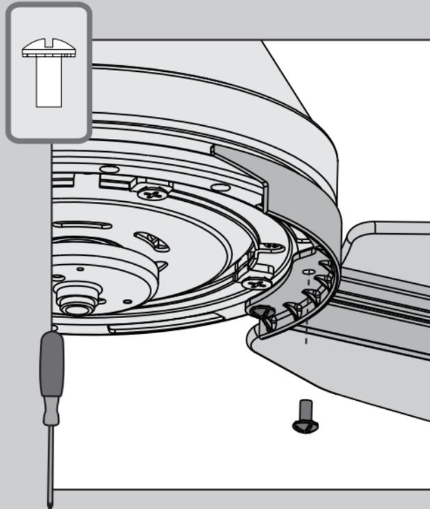
⊗ Acople sin emplear mucha fuerza los soportes de paleta al motor con los tornillos de la bolsa de materiales ⊗, luego apriete con firmeza, cuando ambos tornillos estén acoplados.
