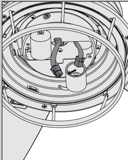
Pase el conector de 9 pines que viene de la parte inferior del alojamiento del motor a través de orificio central en el conjunto de lámparas. Conéctelo en el conector de enchufe que se encuentra en el área de la caja del interruptor del conjunto de lámparas. Asegúrese de alinear las marcas de color de los conectores.
