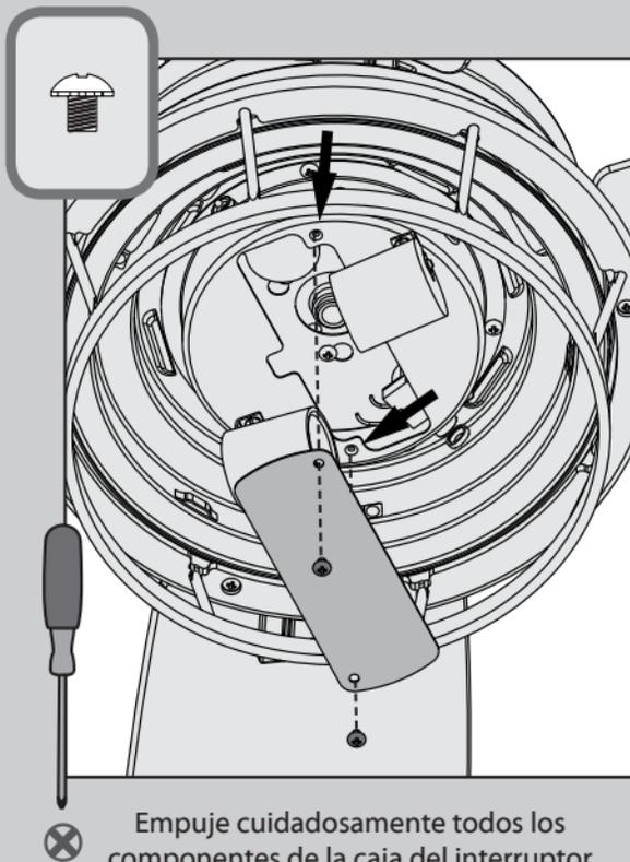
Empuje cuidadosamente todos los componentes de la caja del interruptor en la caja del interruptor, luego instale la placa de la caja del interruptor usando dos tornillos de ensamble del conjunto de lámparas que se encuentran en la
