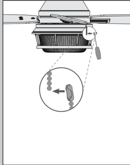
Retire y deseche los conectores de plástico de los extremos de los tiradores de cadena. Coloque el pendiente de cadena adecuado en cada una de las cadenas cortas que salen de la cubierta ornamental y de la tapa de la cubierta ornamental. El tirador de cadena del ventilador controla la velocidad: de velocidad alta a apagado. El tirador de cadena de luz controla el accesorio de luz: encendido y apagado.
