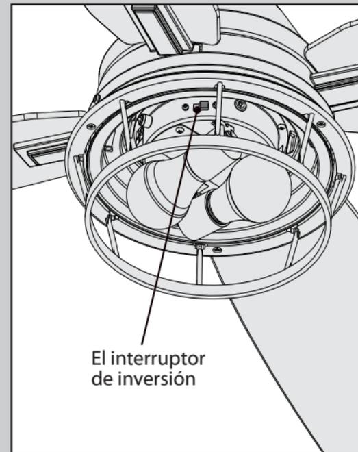
**Para cambiar la dirección del flujo de aire**, mueva el interruptor de inversión a la posición opuesta. Reinstale el conjunto de pantalla.
