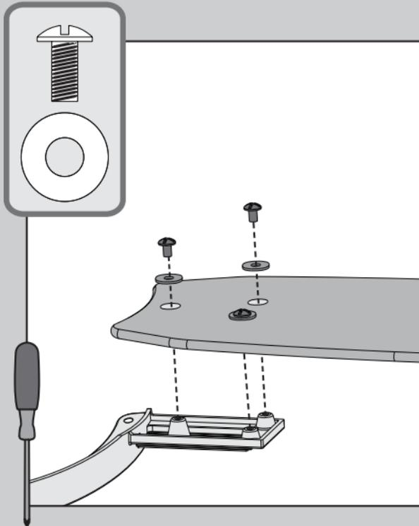
⊗ Fije cada aspa a un soporte de aspa usando las arandelas, que están en la bolsa ■, de aspa y los tornillos de montaje de aspa, que están en la bolsa ▲.
