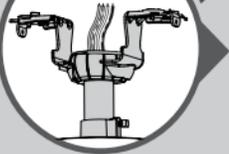
Usando un conector de alambre anaranjado de la bolsa de materiales ★, conecte los 3 alambres de puesta a tierra (verde, verde con banda amarilla, y cobre desnudo) del ventilador, la varilla y el soporte de suspensión.
