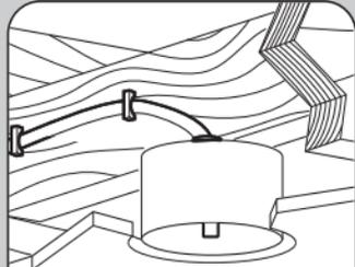
Debe tener la capacidad de asegurar el ventilador a la estructura de la edificación o caja de salida aprobada para ventiladores
