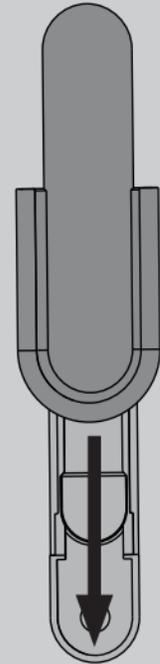
Deslice la base sobre el soporte ya montado.
