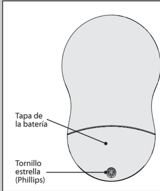
Para acceder al compartimiento de la batería quite el pequeño tornillo estrella (Phillips) que fija la tapa del compartimiento al conjunto del transmisor. La batería debe instalarse con el lado positivo (+) hacia arriba. Reemplace la batería CR2032 según sea necesario.
