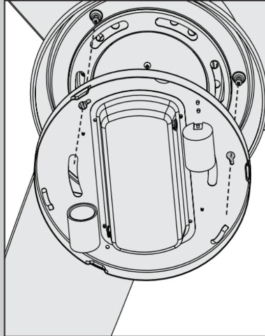
Alinee las ranuras de bocallave en la caja del conjunto de lámparas con los tornillos de la caja del interruptor. Asegúrese de que todos los cables del ventilador y del conjunto de lámparas estén ajustados dentro del centro del conjunto de lámparas, y que no estén atascados entre la caja superior del interruptor y el conjunto de lámparas o colgando de los lados.
