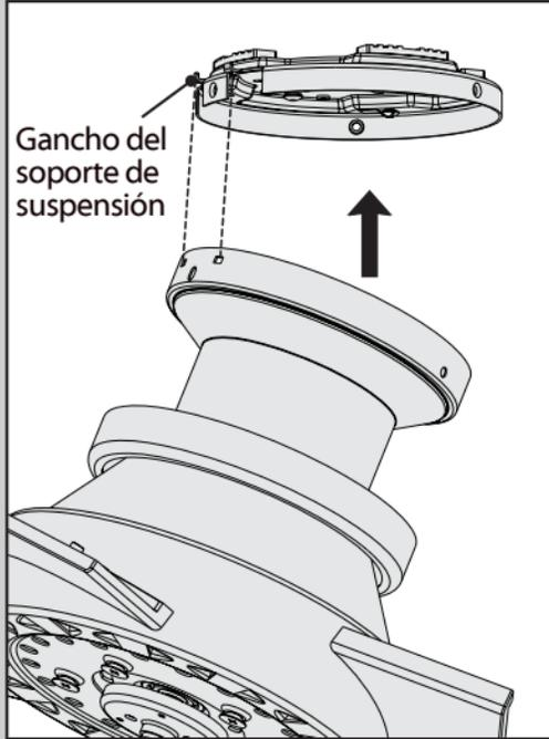
Levante el ventilador y alinee las ranuras en la campana con los ganchos en el soporte de suspensión.
