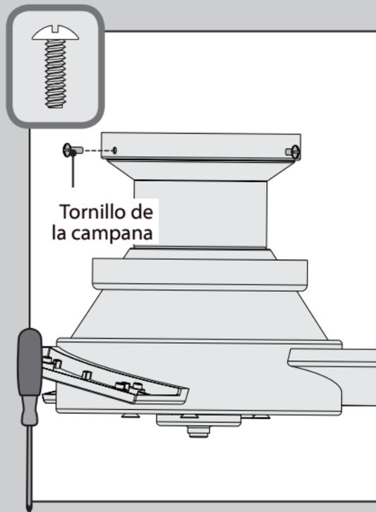
⊗ Sostenga arriba la campana con los orificios para tornillos bien alineados. Instale parcialmente dos tornillos de la campana, que se encuentran en la ● bolsa de materiales, dentro de los orificios opuestos a los ganchos del soporte de suspensión.
