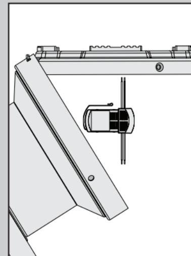
Coloque el receptor dentro de la campana. Asegúrese que los cables se mantengan conectados.
