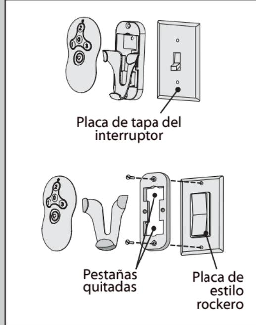
Para instalar el soporte del transmisor, quite los dos tornillos que sujetan la placa de tapa del interruptor. No retire la placa de tapa. Para orientar el soporte, alinee los dos orificios de montaje con los orificios de la placa de tapa. Coloque y apriete los tornillos. No apriete en exceso.
