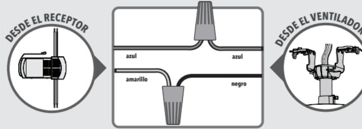
**5 Conectando cables del receptor y del ventilador al techo**
