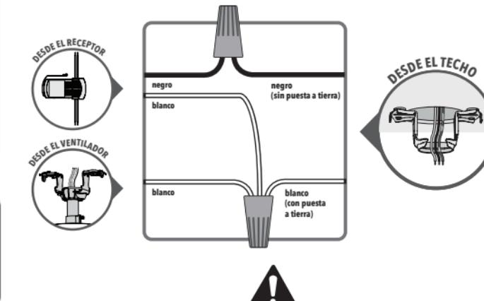
Gire los empalmes hacia arriba y presínelos cuidadosamente hacia atrás a través del soporte de suspensión dentro de la caja de salida. Separe los alambres, con los alambres puestos a tierra a un lado de la caja de salida y los alambres no puestos a tierra al otro lado de la caja de salida.
