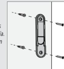
Si está instalando sobre un panel de yeso, perfore dos orificios de 9/64" de ancho usando el soporte de la base como una guía. Martille con cuidado las anclas para panel de yeso incluidas en los orificios previamente perforados.
