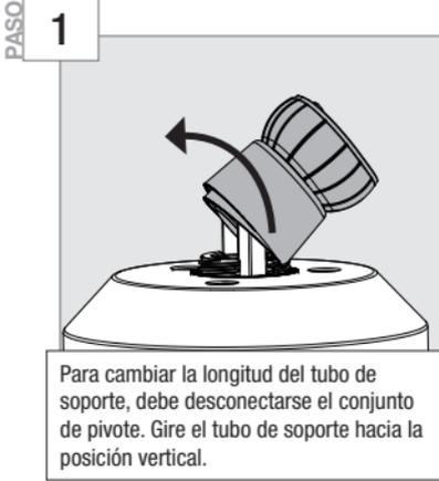
Para cambiar la longitud del tubo de soporte, debe desconectarse el conjunto de pivote. Gire el tubo de soporte hacia la posición vertical.
