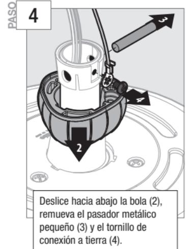
Deslice hacia abajo la bola (2), remueva el pasador metálico pequeño (3) y el tornillo de conexión a tierra (4).
