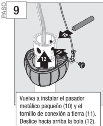
Vuelva a instalar el pasador metálico pequeño (10) y el tornillo de conexión a tierra (11). Deslice hacia arriba la bola (12).
