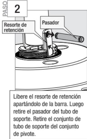
Libere el resorte de retención apartándolo de la barra. Luego retire el pasador del tubo de soporte. Retire el conjunto de tubo de soporte del conjunto de pivote.
