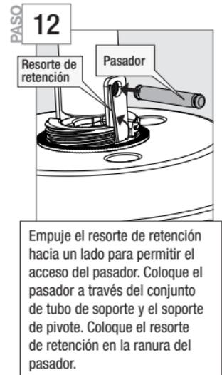
Empuje el resorte de retención hacia un lado para permitir el acceso del pasador. Coloque el pasador a través del conjunto de tubo de soporte y el soporte de pivote. Coloque el resorte de retención en la ranura del pasador.
