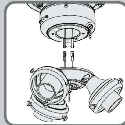
Use los conectores de pin individual para conectar el cable negro o azul del ventilador con el cable negro del juego de luz. Conecte el cable blanco del ventilador al cable blanco del juego de luz.
