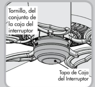
Si la tapa de la caja del interruptor de su ventilador se parece a ésta, quite toda la caja del interruptor; para ello deberá quitar los tornillos de la caja del interruptor con un destornillador estrella (Phillips). Quite los dos tornillos de la tapa desde el interior de la caja del interruptor. Reinstale la caja del interruptor. Apriete los tornillos de la caja del interruptor. A continuación siga las instrucciones de **MONTAJE TIPO A**.
