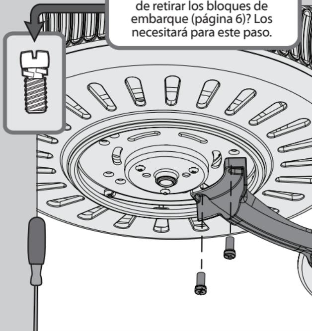
⊗ Acople sin emplear mucha fuerza los soportes de paleta al motor con los tornillos de armadura de soporte de paleta y a continuación apriete con firmeza una vez que ambos tornillos estén acoplados.
