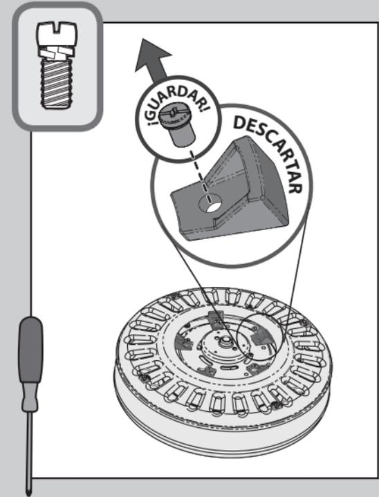
✕ Retire los bloques para transporte del motor. **Guarde los tornillos. Serán necesarios para la instalación del soporte de paleta.**
