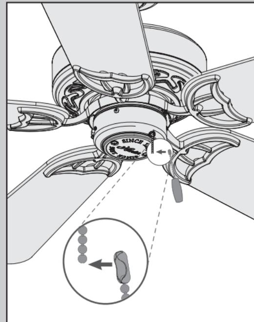
Instalación del pendiente de cadena - Conecte el pendiente de cadena al extremo de la cadena corta que sale de la caja del interruptor.
